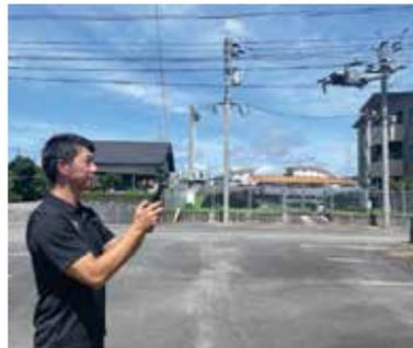
最近は技術も進んできましたので、トータルステーションという最新測量器で距離や角度を測ったり、GPSで位置を割り出したり、より正確な図面を作成しています。ドローンで土地・建物の全体像も調べます。
